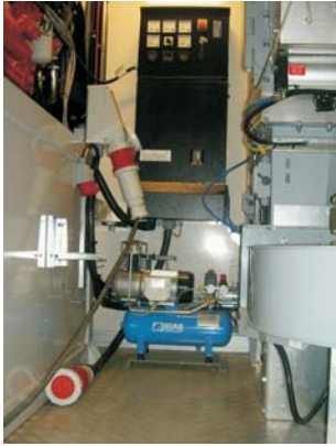
Maskinhuset med Generator, Slangvinda, Dammfilter och Kompressor
