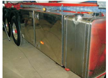
Rostfria förvaringsskåp och diesel tank för generator.
